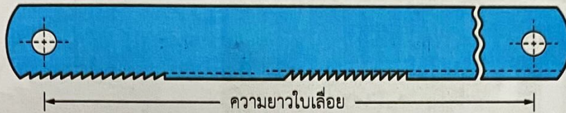
รูปที่ 2.16 การบอกขนาดความยาวของใบเลื่อย
