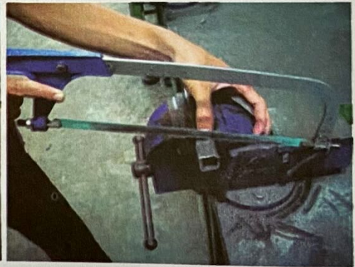
รูปที่ 2.19 การจับชิ้นงานให้จับใกล้ปากกามากที่สุด
