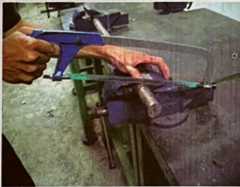
รูปที่ 2.19 การจับชิ้นงานให้จับใกล้ปากกามากที่สุด
