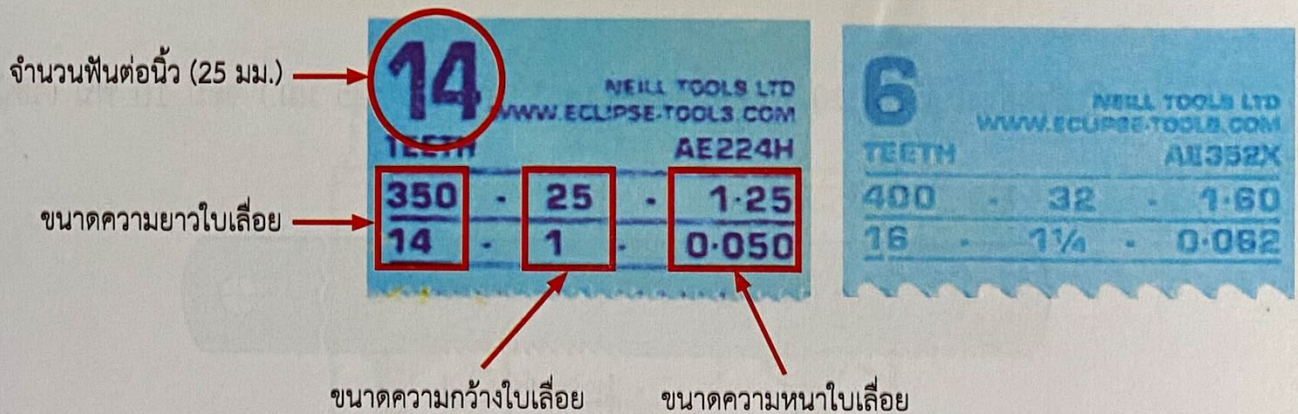
รูปที่ 2.4 การบอกค่าต่าง ๆ ของใบเลื่อยเครื่องกลแบบชัก
