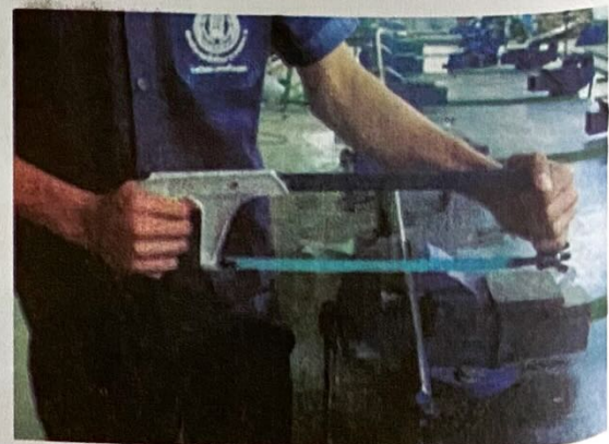
รูปที่ 2.20 การจับโครงเลื่อยเลื่อยชิ้นงาน
