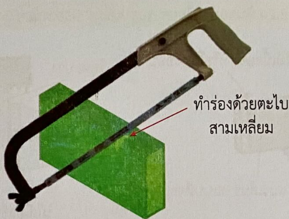
รูปที่ 2.22 ใช้ตะโบสามเหลี่ยมทำร่องนำก่อนเลื่อย
