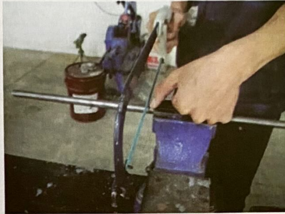
รูปที่ 2.21 ใช้นิ้วหัวแม่มือช่วยประคองใบเลื่อยตรงตำแหน่งที่ต้องการเลื่อย
